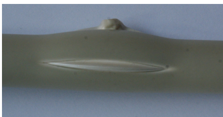
Rys. 5.11. Wygląd zniszczenia i przebieg zmian ciśnienia podczas badania wytrzymałości na ciśnienie wewnętrzne próbki A01
