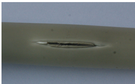
Rys. 5.13. Wygląd zniszczenia i przebieg zmian ciśnienia podczas badania wytrzymałości na ciśnienie wewnętrzne próbki B01
