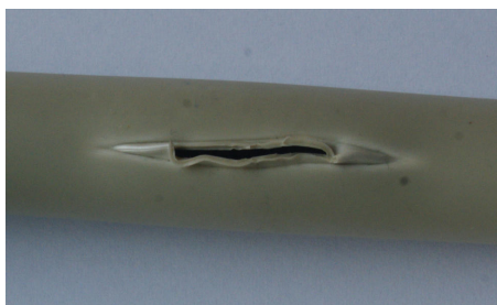
Rys. 5.12. Wygląd zniszczenia i przebieg zmian ciśnienia podczas badania wytrzymałości na ciśnienie wewnętrzne próbki B02
