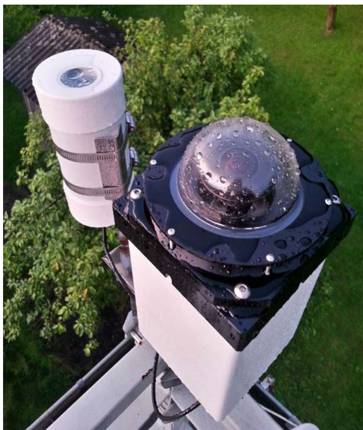
Rys. 1. Stacja ALPS–WRO w swojej pierwotnej formie. Po lewej: fotometr SQM firmy Unihedron, po prawej: kamera SBIG Allsky 340 Źródło: opracowanie własne.
