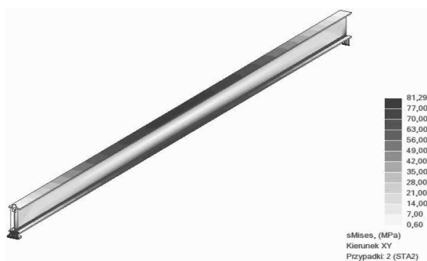
Rys. 6. Wartości naprężeń zredukowanych \sigma_{red} Fig. 6. Reduced stresses map
