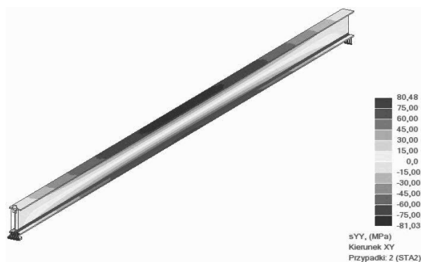
Rys. 5. Wartości naprężeń normalnych \sigma_{yy} Fig. 5. Normal stresses \sigma_{yy}
