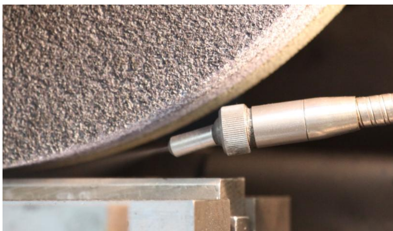
Rys. 2. Sposób podawania płynu chłodząco smarującego przy pomocy systemu MQL
