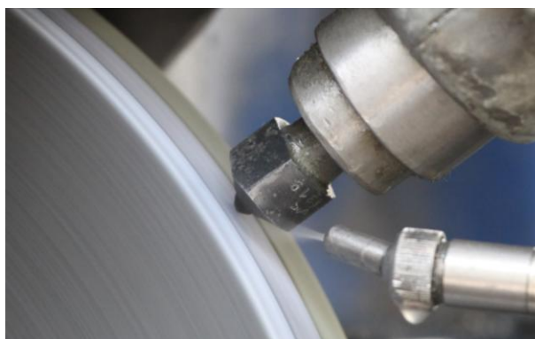
Rys. 3. Proces kształtowania czynnej powierzchni ściernicy
