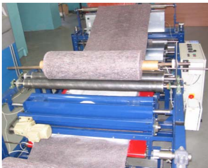
Rys. 2 Modelowa linia do otrzymywania wielowarstwowego kompozytu barierowego
