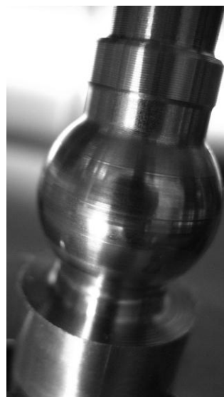
Rys. 7. Widok zdeformowanej powierzchni kulistej po nagniataniu
