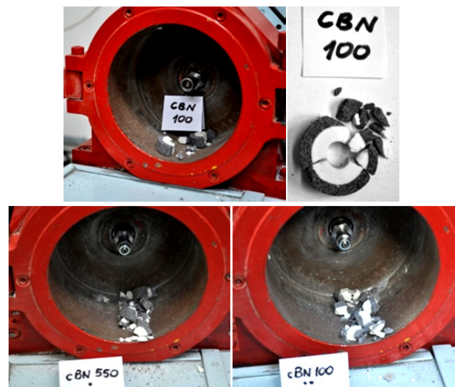
Rys.6. Zniszczenie ściernicy w wyniku rozerwania
