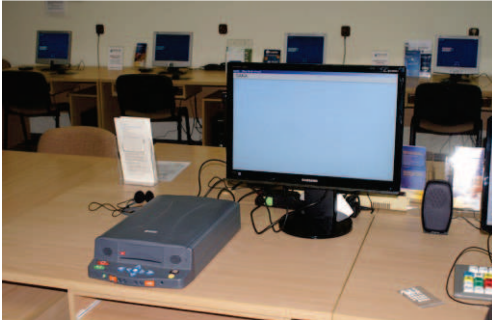
– urządzenie lektorskie SARA (z przeznaczeniem do przetwarzania tekstów drukowanych na materiał dźwiękowy)
