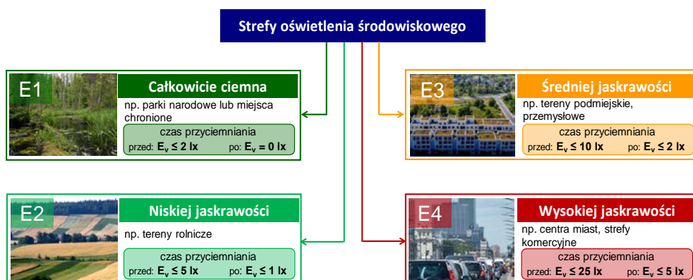
Rys. 2. Graniczne wartości pionowego natężenia oświetlenia dla poszczególnych stref środowiskowych
