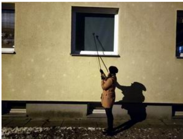
Rys. 3. Pomiar pionowego natężenia oświetlenia na powierzchni okna w budynku mieszkalnym
