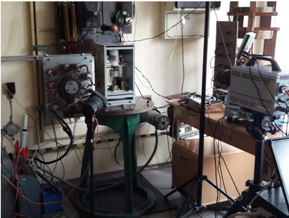
Rys. 26. Stanowisko laboratoryjne do badania NID w próżniowych członach łączeniowych Źródło: opracowanie własne.
