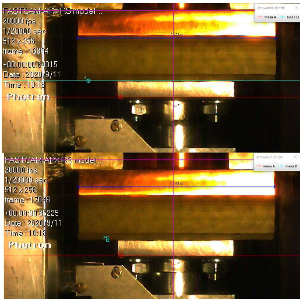
Rys. 29. Wybrane klatki filmu przemieszczenia się styku ruchomego członu łączeniowego
