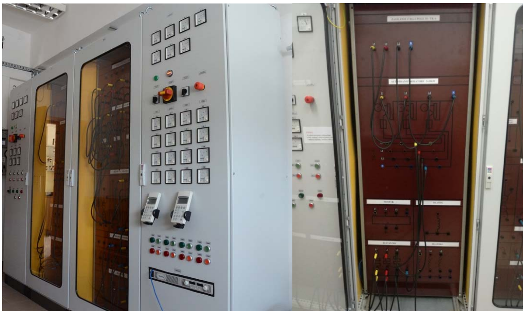
Rys. A. 8. Odbiory energii znajdujące w Laboratorium Generacji Rozproszonej PŁ Źródło: opracowanie własne.
