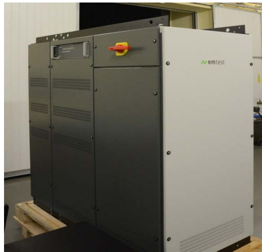
Rys. A. 9. Wzmacniacz NetWave znajdującego się w Laboratorium Generacji Rozproszonej PŁ Źródło: opracowanie własne.
