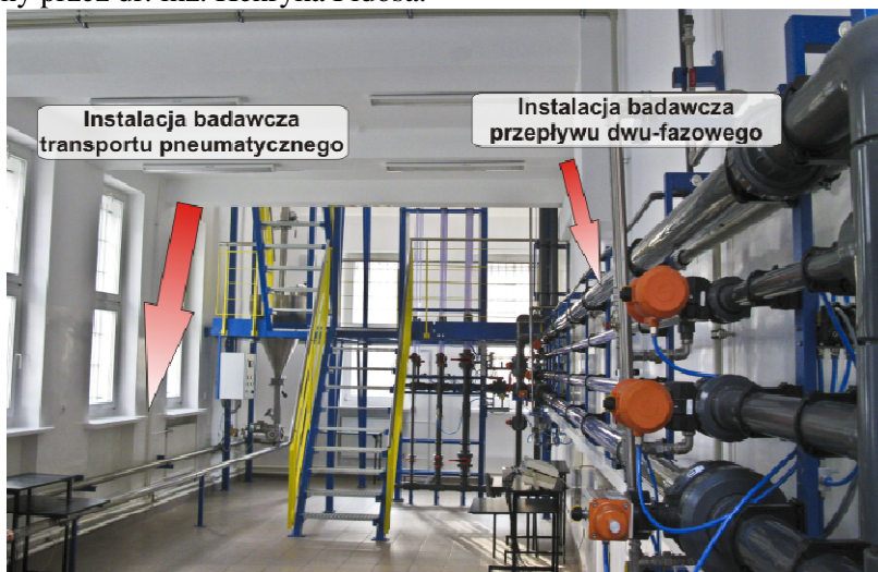
Rys. 1. Widok instalacji do badania przepływów w laboratorium tomografii procesowej
