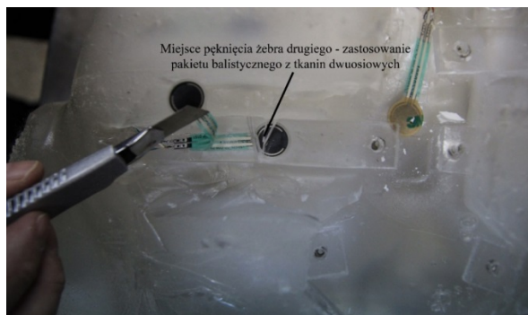
Rys. 7.12. Miejsce pękniętego żebra po badaniach eksperymentalnych
