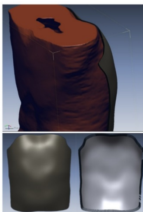
Rys. 7.2. Model geometryczny pakietu balistycznego w postaci zhomogenizowanych powłok 2D
