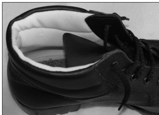
Rys. 3. Wnętrze trzewika z podszewką z dzianiny K-V-dyst.PA/mon.PA/PA
