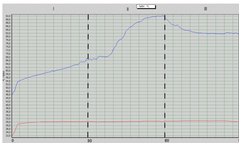
Rys. 5. Przykładowy wynik badania otrzymany dla górnej sondy w trakcie cyklu: I odpoczynek 30 min – II wysiłek 30 min – III odpoczynek linia czerwona – temperatura linia niebieska – wilgotność względna
