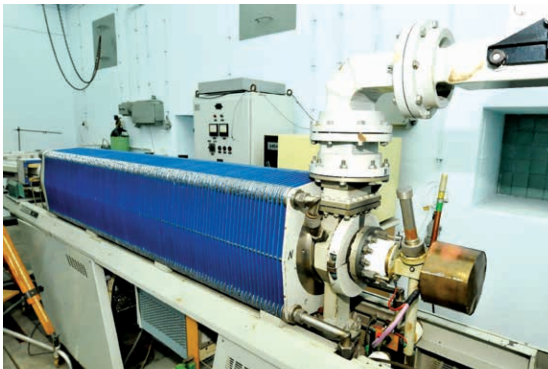
Liniowy akcelerator elektronów w MITR
