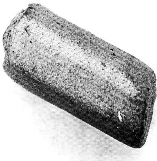
Rys. 1. Zdjęcie ziarna ściernego ze zwykłego korundu spiekanego 76A (pow.40x) [1]
