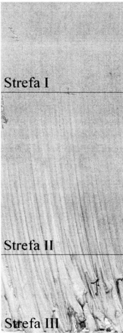
Rys. 1. Ślady wysokociśnieniowego strumienia wodnościernej na powierzchni przecinanego przedmiotu ze stali 1H18N9T, grubość mat. 140 mm
