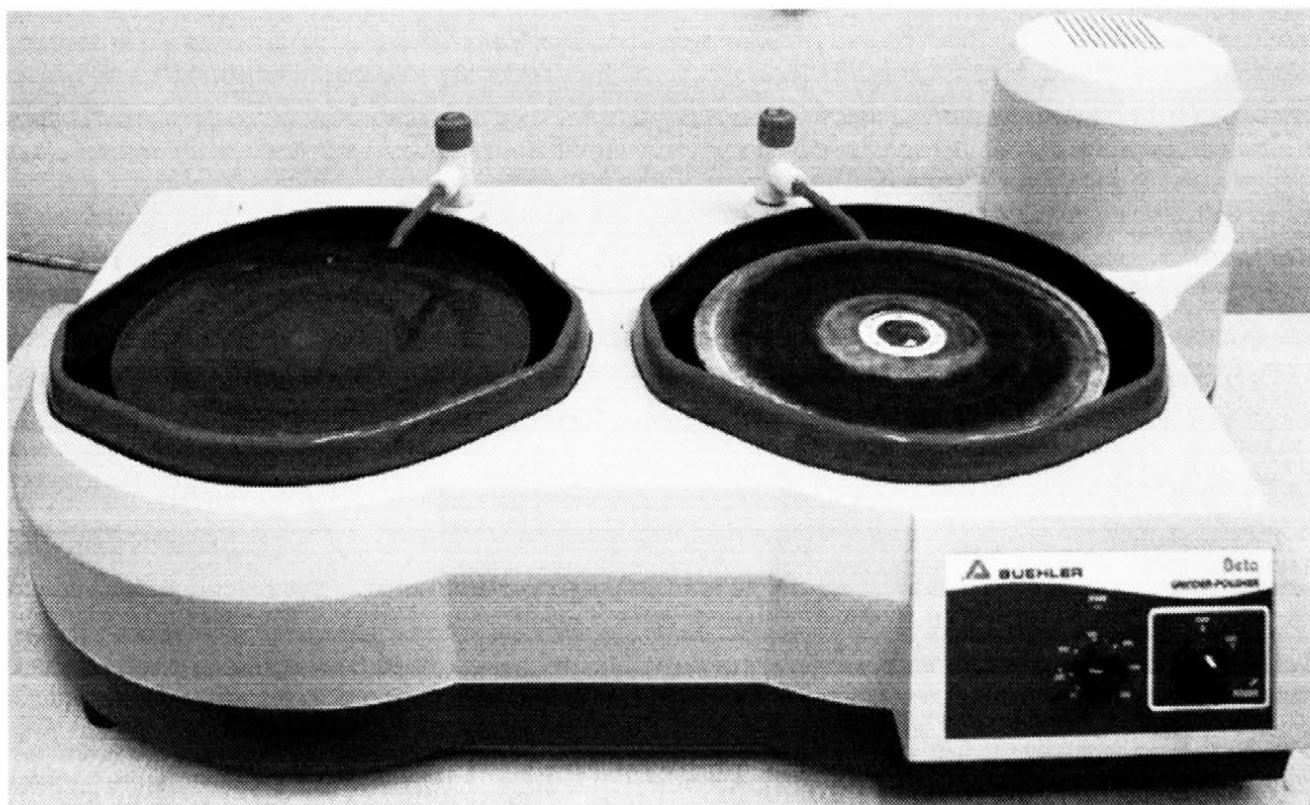
Rys. 2. Widok ogólny szlifierko-polerki Phoenix Beta 2 produkcji firmy Wirtz Buehler
