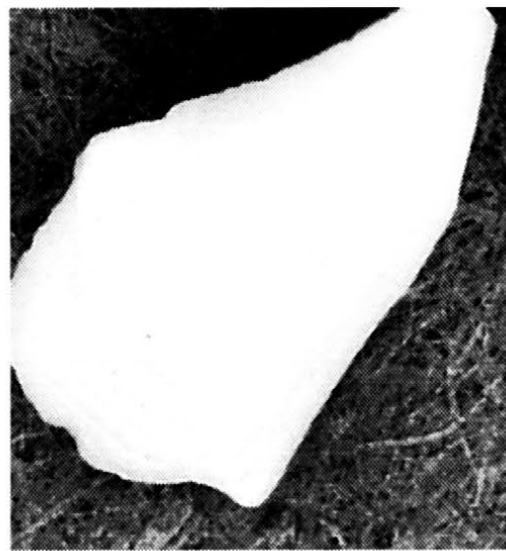
Rys. 2. Zdjęcie ziarna ściernego z submikrokryształicznego korundu spiekanego CB (pow. 40x) [1]
