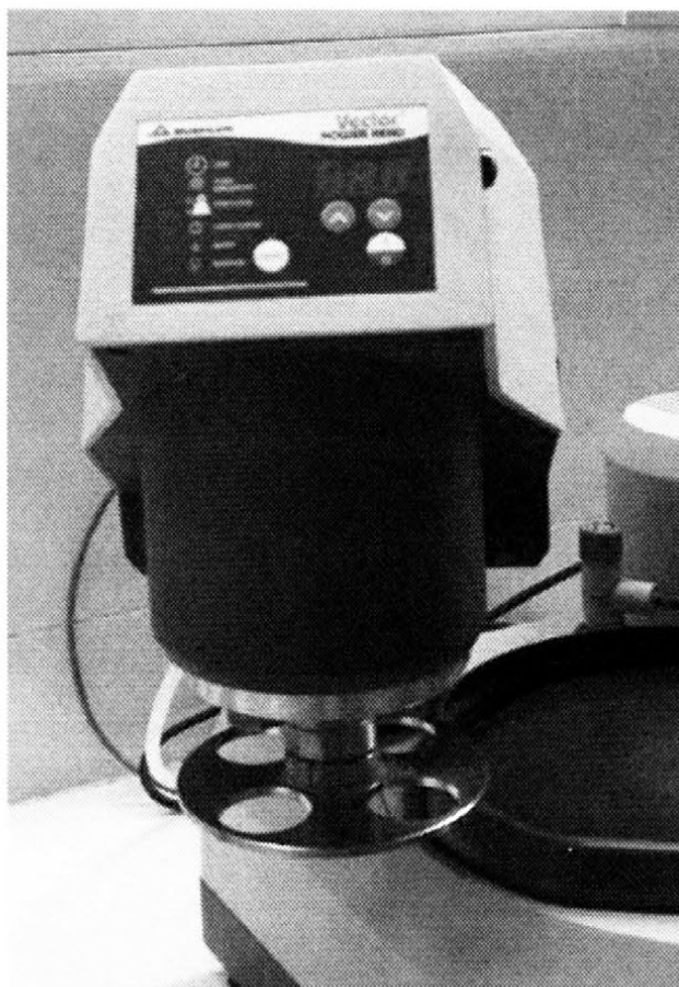
Rys. 4. Głowica półautomatyczna szlifierska Buehler Vector Power Head wraz z uchwytem
