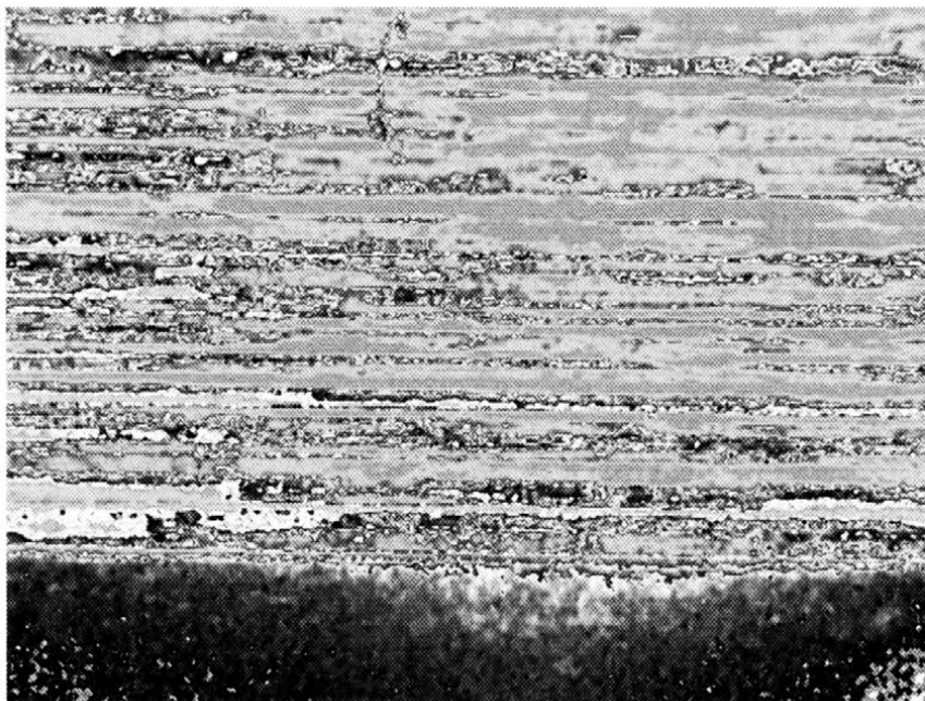
Rys. 6. Mikroskopowy obraz powierzchni próbki ze stali SW18 po szlifowaniu AEDG; U=200\text{V} , I=25\text{A}
