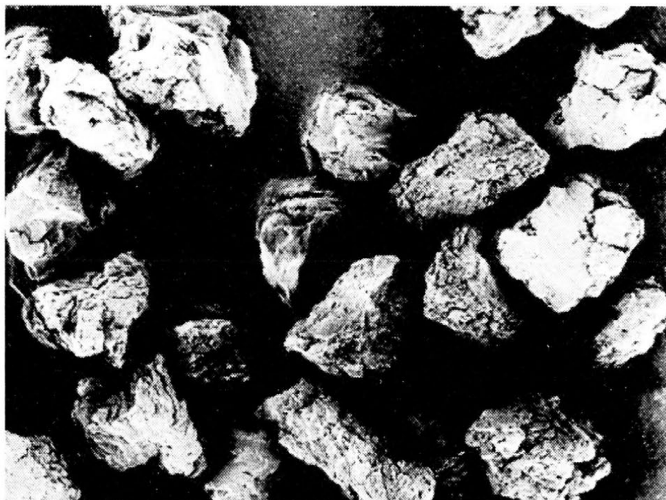
Rys. 5. Ziarna polikrystalicznego diamentu w zawiesinie Buehler Meta Di Supreme (powiększenie 450x) [18]
