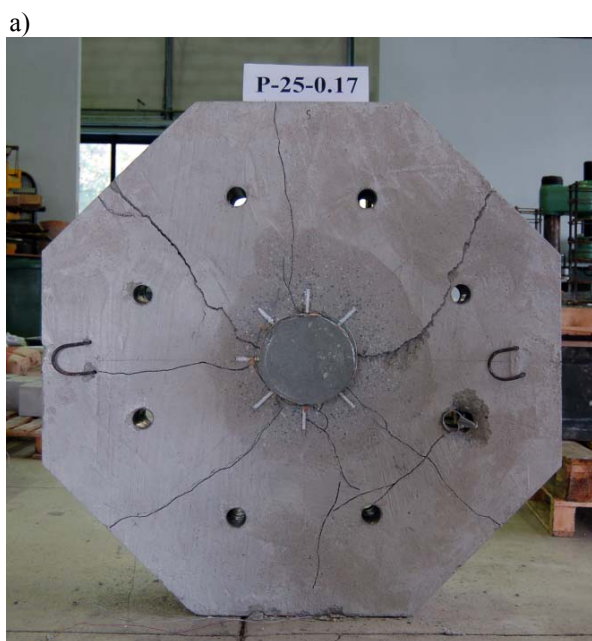
Rys. 3.12. Radialne pęknięcia modeli serii pierwszej: a) P25-0.17, b) P-30-0.14 Fig. 3.12. Radial cracks of first series models: a) P25-0.17, b) P-30-0.14
