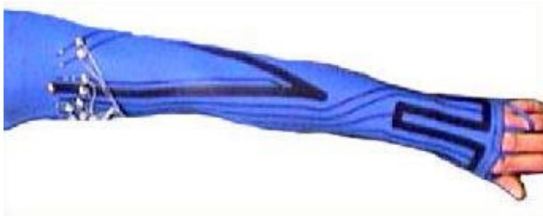
Rys. 1.1. Rękaw zawierający tekstylne czujniki odkształcenia Źródło: (Carpi, De Rossi, 2005).
