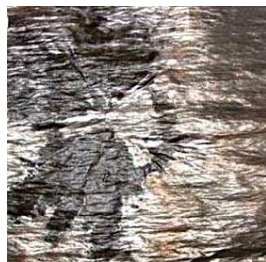
Rys. 3.4. Tkanina pokryta cienkimi powłokami metalicznymi niklu i miedzi Źródło: (Guo i in., 2013).
