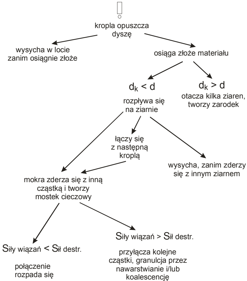
Rys. 5.32. Możliwe zachowanie kropli podczas dostarczania cieczy do złoża Fig. 5.32. Possible droplet behavior during binder supplying to the bed
