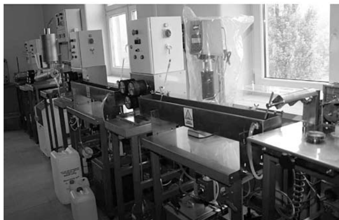
Rys. 1. Ciąg technologiczny do formowania włókien PGLA metodą z roztworu na mokro
