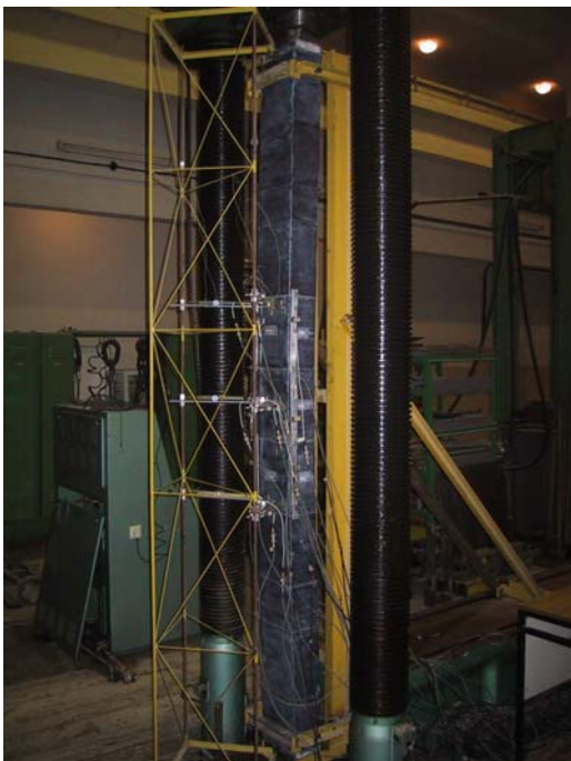
Rys. 3.17. Zniszczenie słupa S-m/2m Fig. 3.17. Failure of column S-m/2m
