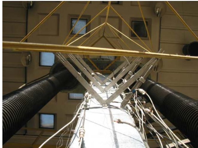
Rys. 2.8. Oprzyrządowanie pomiarowe słupa, widok z dołu
