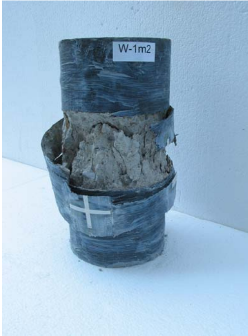
Rys. 3.3. Próbki W-1m2 oraz K-Ft2m2 po zniszczeniu Fig. 3.3. Specimens W-1m2 and K-Ft2m2 after failure
