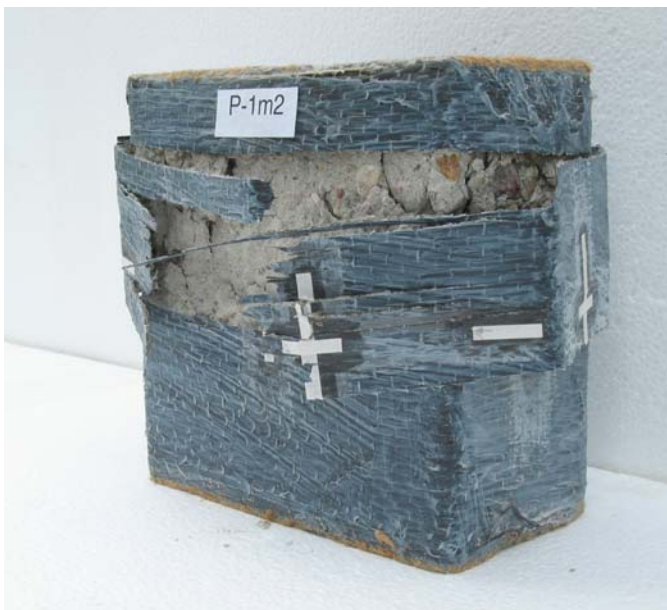
Rys. 3.4. Próbki P-1m1 oraz P-1m2 po zniszczeniu Fig. 3.4. Specimens P-1m1 and P-1m2 after failure
