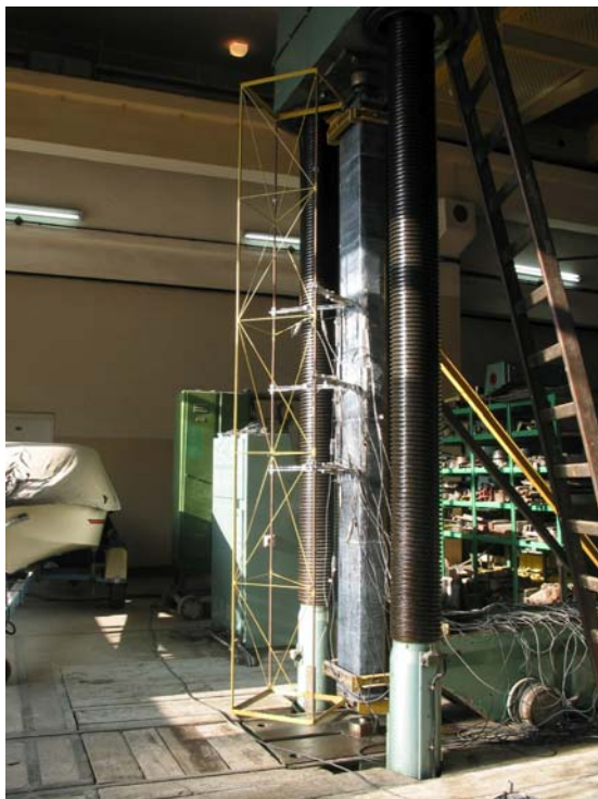
Rys. 2.6. Ogólny widok stanowiska badawczego z widoczną kratownicą do badania przemieszczeń Fig. 2.6. The test set-up of the column with a visible truss for displacement measurements
