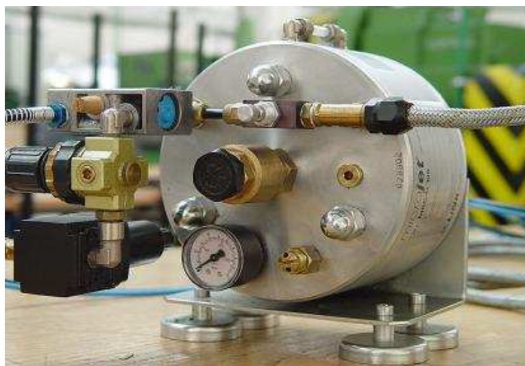
Rys. 2 Urządzenie do wytwarzania mgły olejowej MQL firmy Micro JET 3000.
