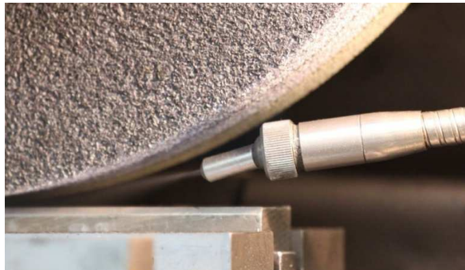
Rys. 1. Sposób podawania płynu chłodząco smarującego przy pomocy systemu MQL[nsos35]
