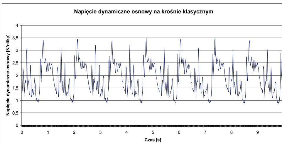
Rys. 9. Przebieg napięcia dynamicznego osnowy na krośnie klasycznym
