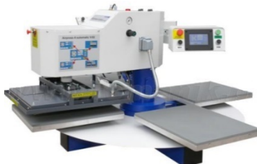
Rys. 2. Maszyna do laminowania szwów – Prasa Schulze Airpress 4 plus automatic [9]
