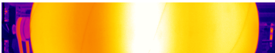
Rys. 1. Wycinek powierzchni walca w polu widzenia kamery (120px wysokości)
