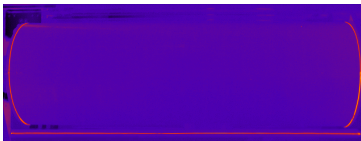
Rys. 2. Znaczniki cieplne: widoczne kontury walca oraz znacznik poziomy, zamontowany na konstrukcji
