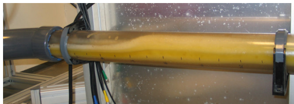
Rys. 6. Przykład przepływu występującego podczas powolnego rozruchu pompy
