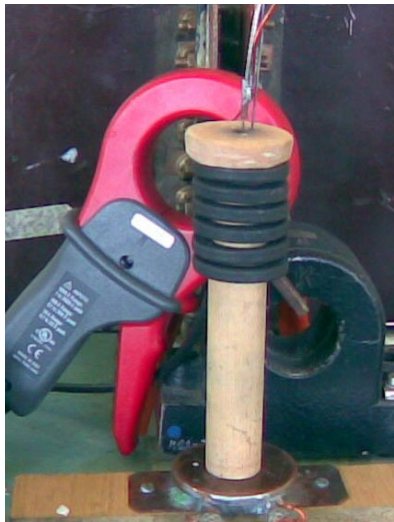
Rys. 4. Układ wzbudnik-próbka badawcza wsadu
