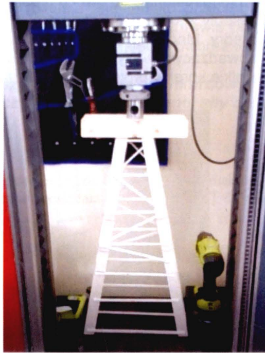
Fot. 2. Obciążenie próbnej wieży w laboratorium KMM na Wydziale BAIŚ PŁ
