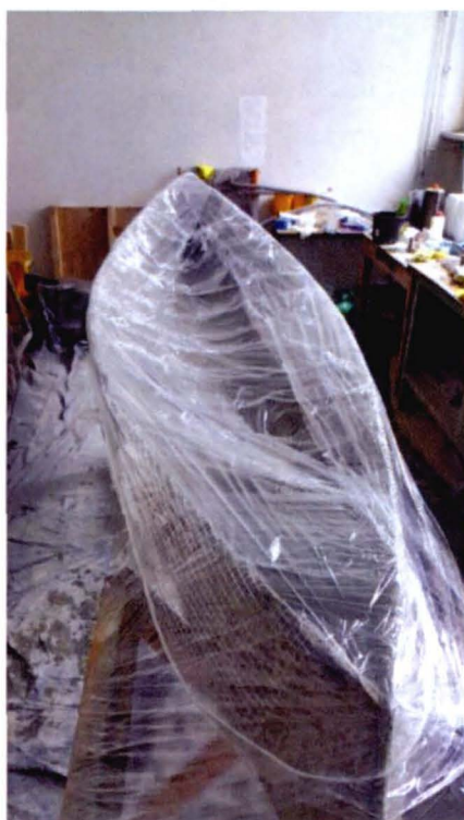
Fot. 5. Pielęgnacja betonowego kajaka
