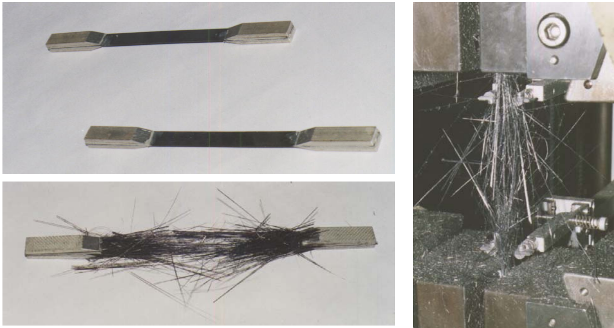
Rys. 3.4. Taśma CFRP przed badaniem, po badaniu oraz w maszynie wytrzymałościowej w chwili zniszczenia Fig. 3.4. CFRP strip before and after the test and in strength testing machine at failure
