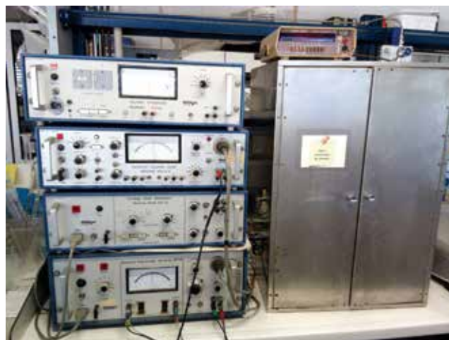
Fot. 2. Stacja elektrochemiczna (fot. A. Danielewicz, A. Rosiak)
