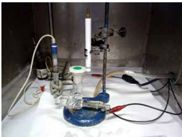
Fot. 3. Układ do polimeryzacji elektrochemicznej (fot. A. Danielewicz, A. Rosiak)
