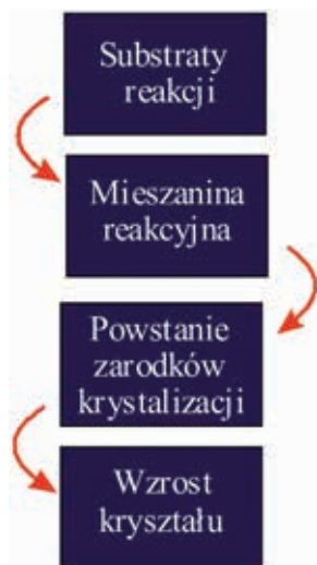
Rys. 1. Etapy hydrotermalnej syntezy zeolitów
