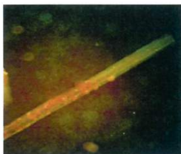
Rys. 4. Mikroskopowy obraz włókna lnu odmiany Modran i bakterii Staphylococcus aureus – bakterie w kolorze pomarańczowym są martwe, zielone punkty na obrazie oznaczają żywe bakterie; Mikroskop fluorescencyjny Nikon Eclipse E200, powiększenie x100
