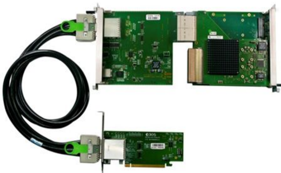
Rysunek 25 Przewodowy interfejs PCIe x16 generacji 3 do zewnętrznego komputera przetwarzającego dane, dedykowany dla systemów bazujących na standardzie MTCA.4 [H17].
