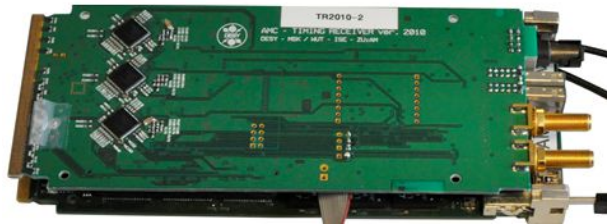
Rysunek 8 Zdjęcia modułów AMC A systemu LLRF: a) moduł do pomiaru promieniowania gamma i neutronowego [H5], b) modulator wektorowy, c) moduł synchronizacji czasowej z dołączonym modulem cyfrowym AMC B.
