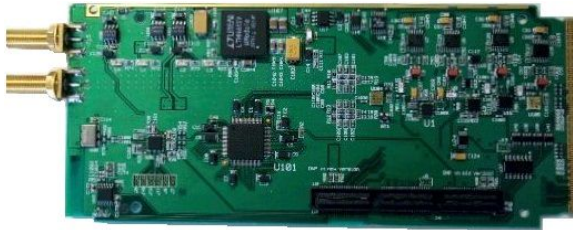
Rysunek 8 Zdjęcia modułów AMC A systemu LLRF: a) moduł do pomiaru promieniowania gamma i neutronowego [H5], b) modulator wektorowy, c) moduł synchronizacji czasowej z dołączonym modulem cyfrowym AMC B.
