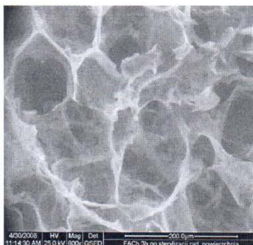
SEM powierzchni zewnętrznej gąbki wytworzonej z microfibril chitozanowo- alginianowych z dodatkiem Ca.
