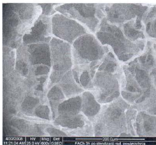
SEM powierzchni zewnętrznej gąbki wytworzonej z microfibril chitozanowych
