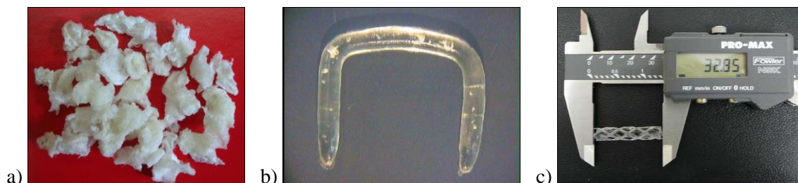
Rys. 6. Bioresorbowalny terpolimer poli(L-laktyd-glikolid-trimetylowęglan) wykazujący właściwość pamięci kształtu, odpowiednio: a) w postaci poreakcyjnej, b) przetworzony w postaci klamry chirurgicznej, c) przetworzony w postaci stentu tchawiczego.
