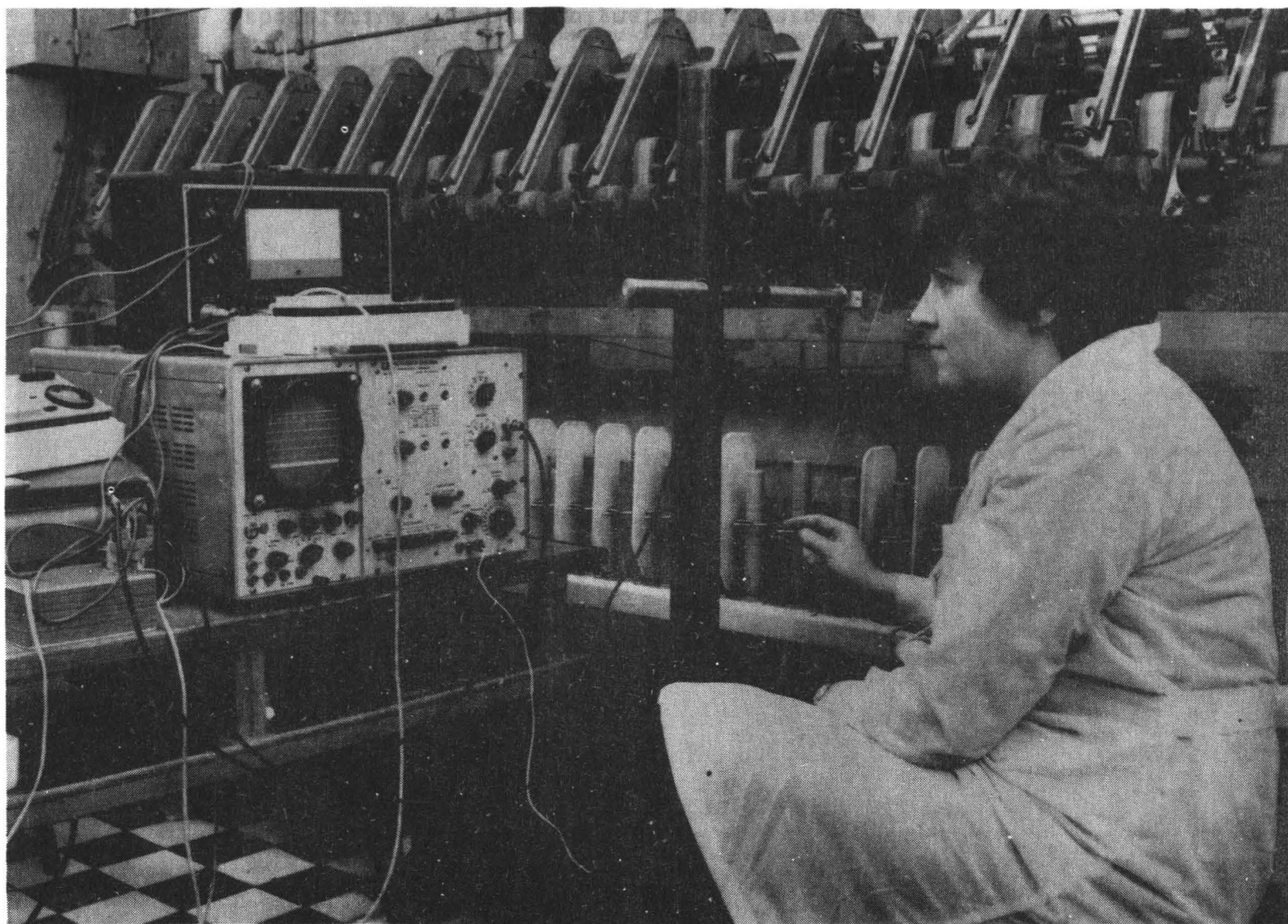
Laboratorium Przędzalnictwa. Badanie warunków technologicznych przędzenia na przędzarce obrączkowej (I-23)
