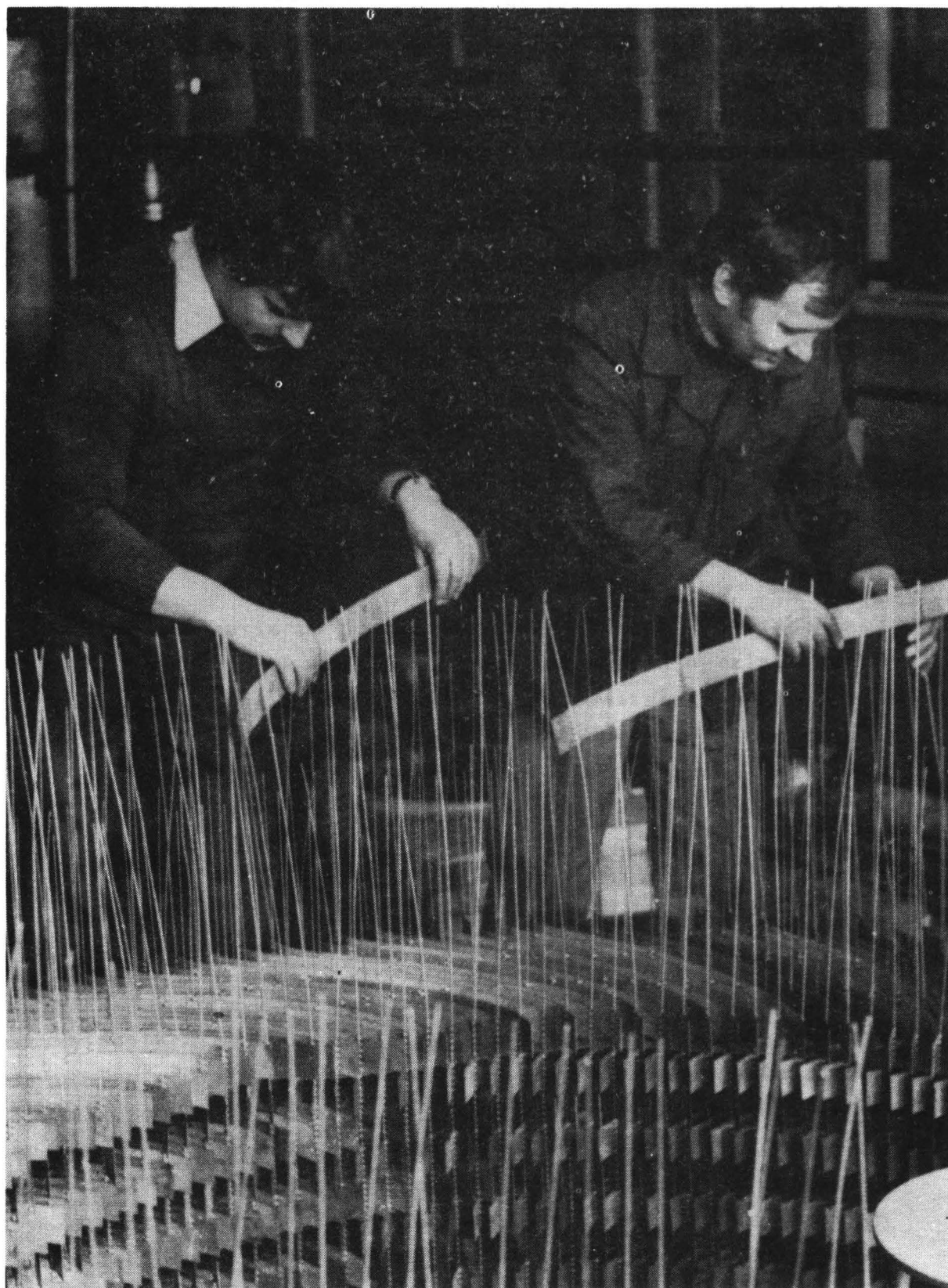
Montaż skraplacza typu Multiwir w warsztacie mechanicznym Instytutu
