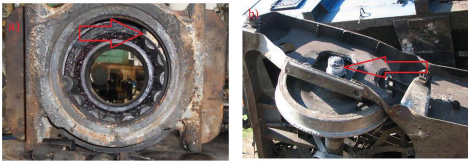
Rys. 3. Skutki uszkodzenia łożyska osiowego:
