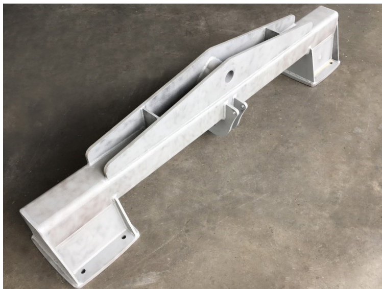
Rys. 11. Konstrukcja po procesie piaskowania
