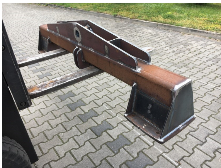
Rys. 10. Pospawana konstrukcja blachowa
