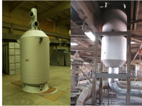
Rys. 15. Tłumik hałasu wydmuchu pary na hali produkcyjnej OTC IEN Źródło opracowanie własne.
