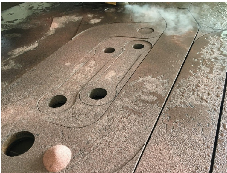
Rys. 7. Proces cięcia cięgieł na wykrawarce wodnej z gannetem mesh 80 Źródło: opracowanie własne.
