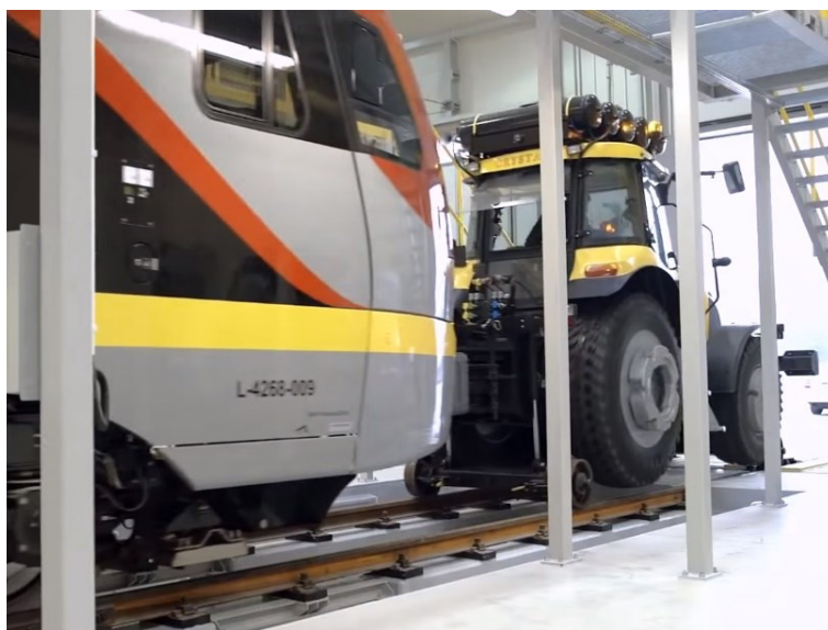
Rys. 14. Prace manewrowe pojazdu ORION 9C160 ze sprzęgiem SA-3
