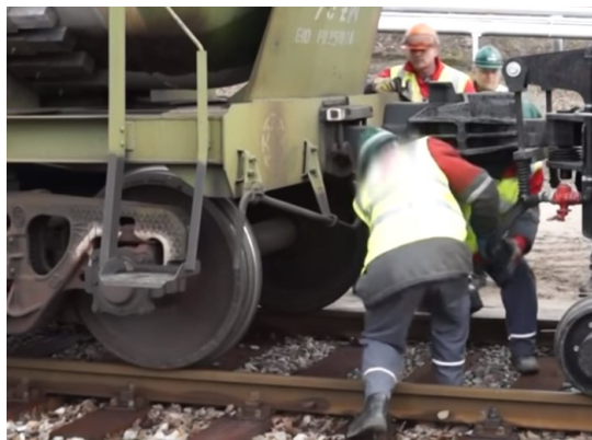
Rys. 4. Ilustracja obrazuje ryzyko dla operatora podczas sprzęgania pojazdów bez zderzaków kolejowych
