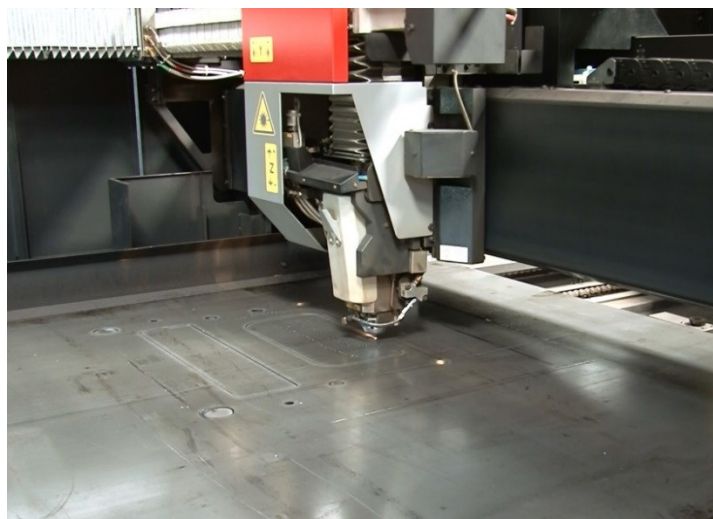
Rys. 6. Proces cięcia laserowego na wykrawarce laserowej CO2 4000 kW
