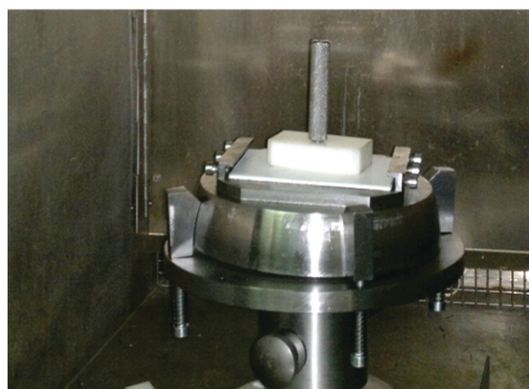
Rys. 8.3. Uchwyt zapewniający przegubowe podparcie końców słupa: a) konstrukcja rzeczywista, b) schemat ideowy uchwyty – przekrój
