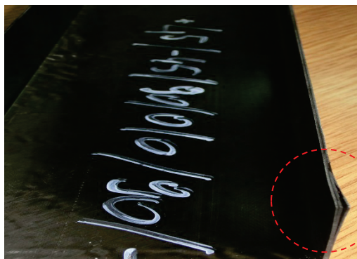
Rys. 10.27. Zniszczenie słupa C4 – delaminacja naroża
