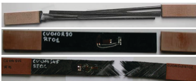
Rys. 7.7. Próbkę po badaniach właściwości granicznych kompozytu – od góry: układ 0^{\circ} , 90^{\circ} , \pm 45^{\circ}
