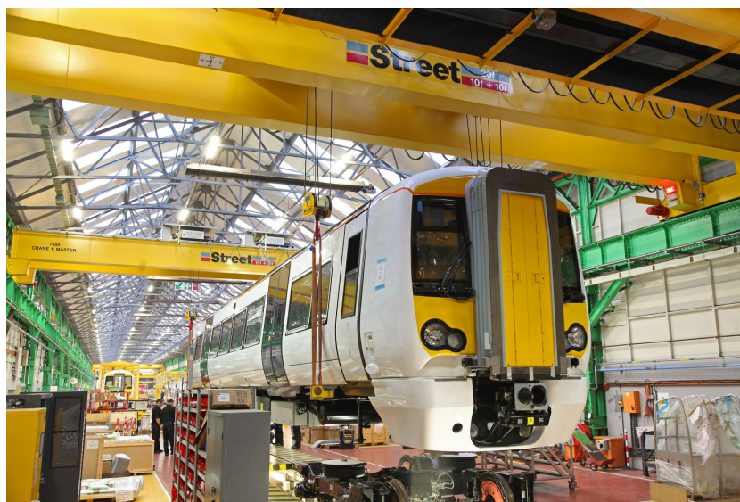
Fot. 1.3. Suwnice montażowe wagonów
