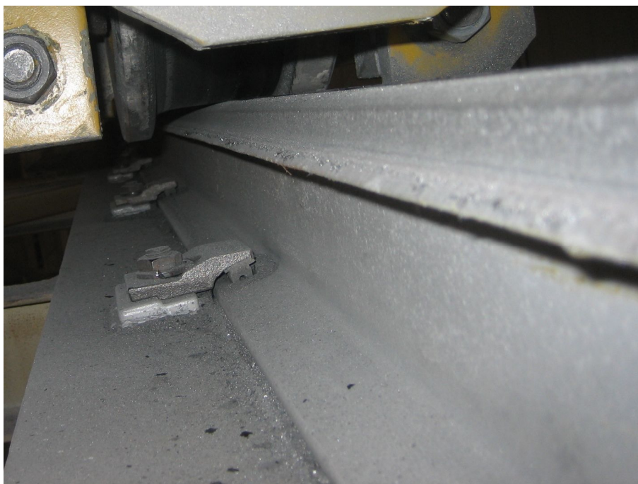
Fot. 6.1. Powierzchnie boczne główek torów oraz obrzeża kół
