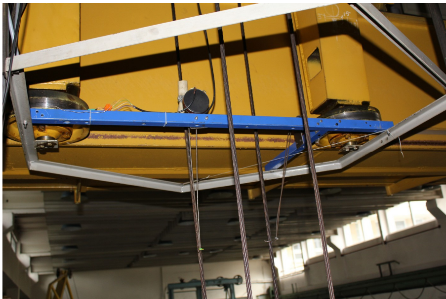
Fot. 5.8. Zestaw czujników potencjometrycznych do pomiaru wychylenia ładunku
