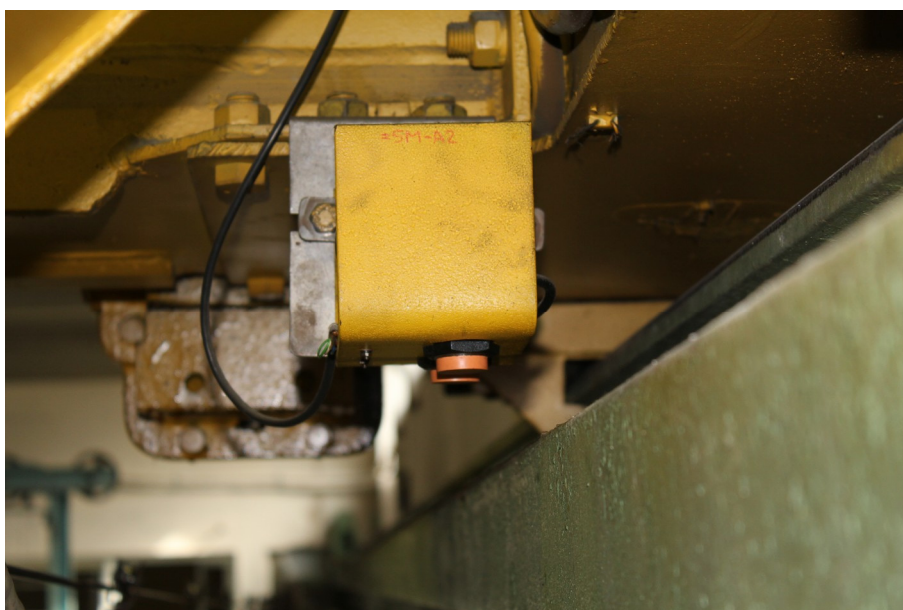
Fot. 5.7. Zestaw czujników korekcji położenia lewej czołownicy
