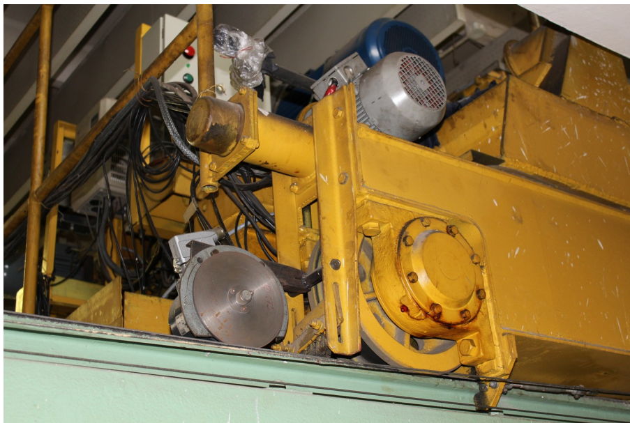
Fot. 5.4. Przetwornik sprzężony z kołem pomiarowym wleczonym
