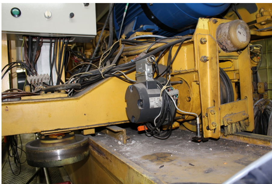
Fot. 5.5. Przetwornik sprzężony z kołem nienapędzanym wózka
