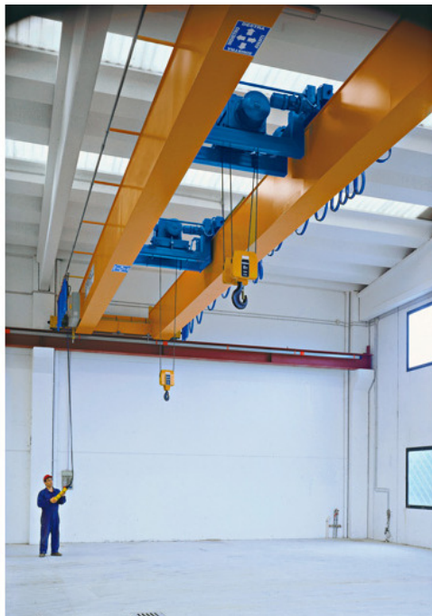
Fot. 1.2. Suwnica z dwoma wciągarkami
