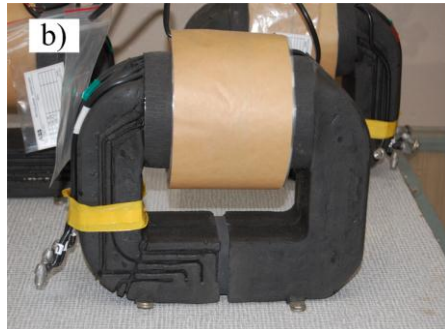
Rys. 4.3. Niskonapięciowe modele przekładnika napięciowego SN (Przekładnik fabryczny: U_{pn} = 22/\sqrt{3} \text{ kV} ; U_{sn} = 110/\sqrt{3} \text{ V} i 110/3 \text{ V} )
